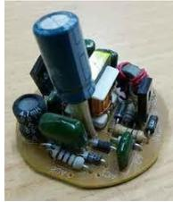
Gambar 1. Bentuk Fisik Ballas Elektronik
